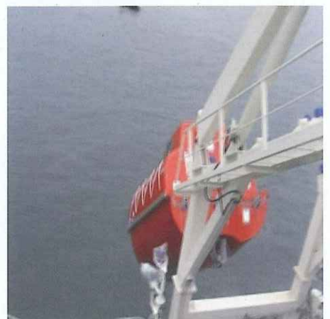
船尾に取り付けられ、緊急時は最高22mの高さから落下させるフリーフォール救命艇の衝撃テストのようす。
