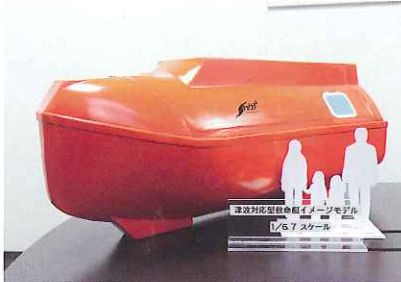
最終設計の終わった信貴造船所オリジナルの津波対応型救命艇の模型(6.7分の1)。
